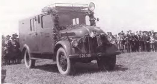
Umgebauter STEYR-DAIMLER PUCH aus Wehrmachtbeständen Motor: 8 Zylinder-3.5 Liter-Luftgekühlt 75 PS
